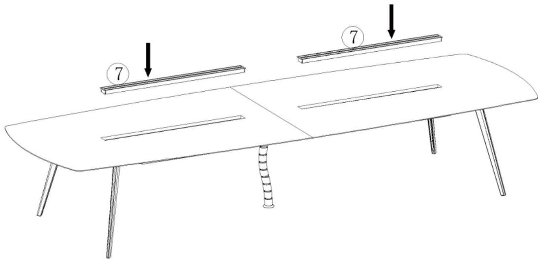
⑦电力导轨（另附连接电源线视频）
