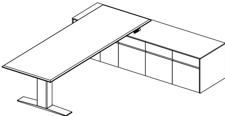
**8** 安装说明：底部安装控制器，盖上吊线盒
