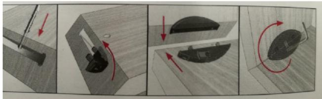
拉米诺连接安装示意图
