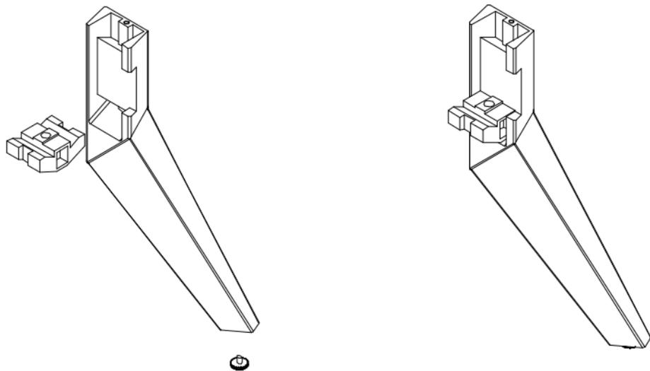
放置下夹头、安装防滑脚垫
