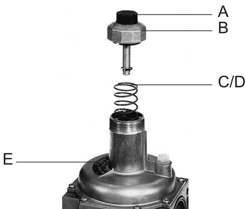
1. 取走保护盖A。用螺丝刀逆时针转动主轴B可松开弹簧。将主轴转到底。
