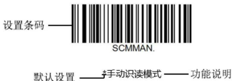
将识读窗口对准条码中心，移动平台并调整它与条码之间的距离，来找到最佳识读距离；听到成功提示音响起，同时红色照明线熄灭，则读码成功，平台将解码后的数据传送至主机。
